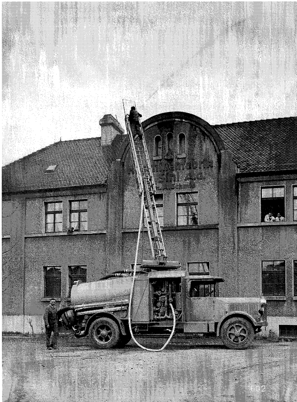
Produktfoto der Maschinenfabrik an der Sihl in Zürich: Schlammsaugwagen mit ausgezogener Leiter, 1934 (Schweizerisches Wirtschaftsarchiv, P 524).
